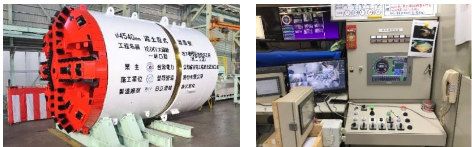
圖九 本工程所採土壓平衡式潛盾機(左)及遠端操作系統(右)
