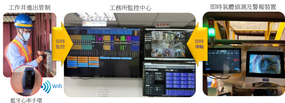
圖四 局限空間即時定位與生命徵象監控系統(PVMS 系統)
